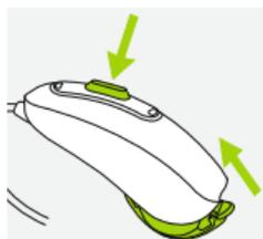
Para activar el modo avión, mantenga apretado el botón pulsador durante 10 segundos a la vez que cierra la tapa del portapilas. Para desactivar el modo avión, simplemente abra y cierre la tapa del portapilas de nuevo.
