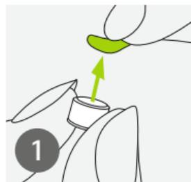
1 Retire el plástico protector de la pila nueva y espere dos minutos.
