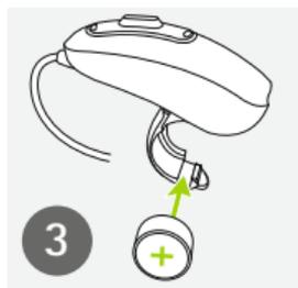
3 Coloque la pila en el portapilas con el símbolo "+" hacia arriba.
